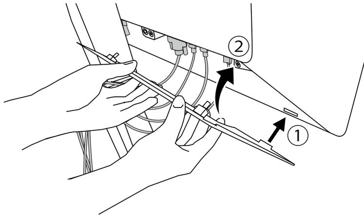
Пример: Установка кабельной крышки (справа)
