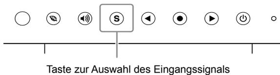
Wechseln Sie mit der Taste **(S)** das Eingangssignal. Das Eingangssignal wechselt bei jedem Drücken der Taste **(S)**. Wird das Eingangssignal gewechselt, erscheint für 3 Sekunden der aktive Signaltyp (Analog oder Digital) oben rechts im Bildschirm.
