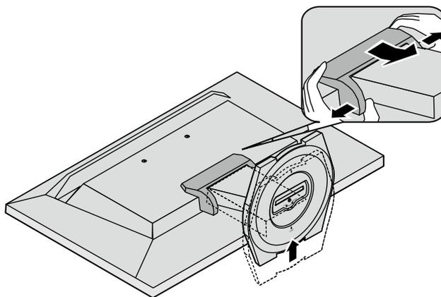
2. Desserrez les vis (trois) fixant l'appareil et le pied.
