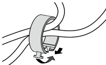
3. Toute en maintenant la section fermée, insérez l'enveloppe de câbles dans la base du pied.
