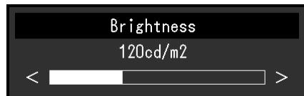
3. Выполнить регулировку/настройку выбранного элемента с помощью кнопок **<** **>**, затем нажать **✓**.
