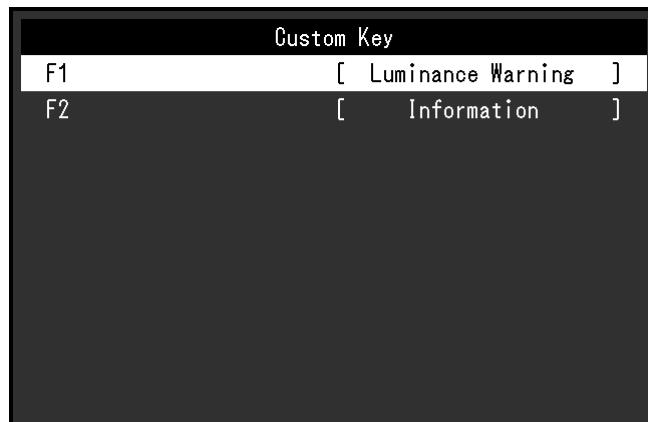
4. Используйте **Λ** **∨** для выбора пользовательской клавиши, на которую следует назначить функцию, а затем нажмите **✓**.
