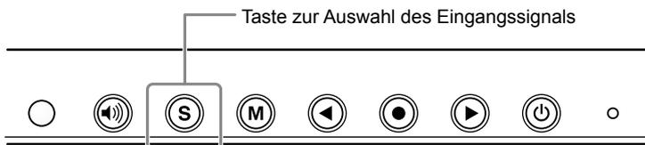
Wechseln Sie mit der Taste (S) das Eingangssignal. Das Eingangssignal wechselt bei jedem Drücken der Taste (S). Wird das Eingangssignal gewechselt, erscheint für 3 Sekunden der aktive Signaltyp (Analog oder Digital) oben rechts im Bildschirm.
