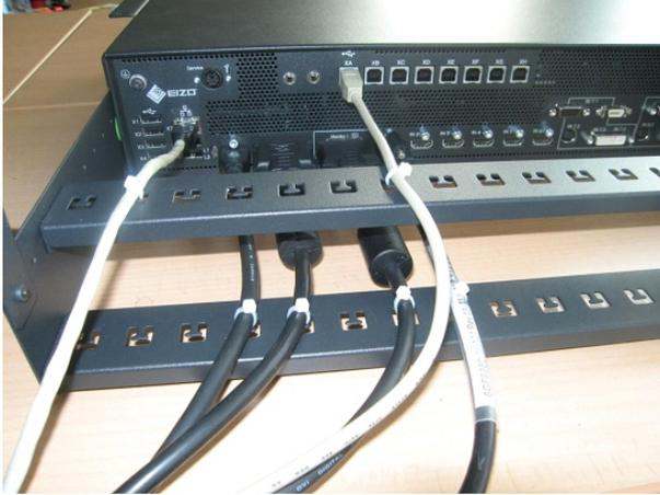
Zum Fixieren der Kabel können Kabelbinder mit 3 mm Breite eingesetzt werden.
