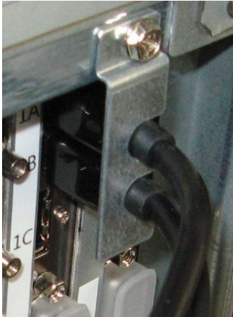
Abb. 2: Angeschraubte Halterung mit DP-Steckern
