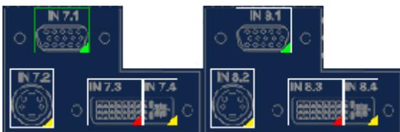
Wenn Sie mit der linken Maustaste auf den zu konfigurierenden analogen Videoeingang IN7.1, IN7.2, IN7.4, IN8.1, IN8.2 oder IN8.4 doppelklicken, wird das Dialogfenster "Konfiguration des Videoeingangs" angezeigt.
