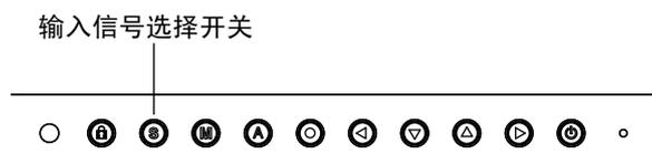
当显示器与两台计算机连接时，此功能可选择其中一台计算机作为优先控制显示器。显示器持续检测输入信号并自动变为“优先输入”所设置模式（见下面图表）。一旦优先权已设定，无论何时输入信号改变，显示器都将输入信号切换为“优先输入”信号。
