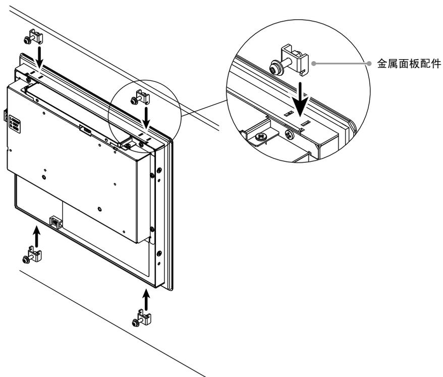
3. 用  $0.6-0.7\text{N}\cdot\text{m}$  的指定转矩，固定金属面板配件的螺丝。
