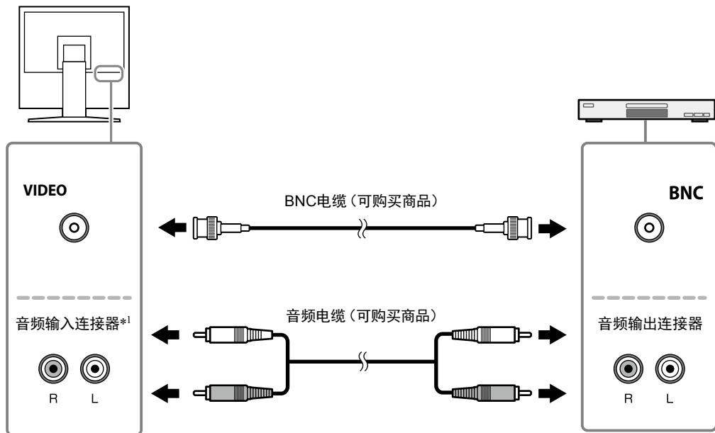
\*1 设备只配有一个系统的声频输入插孔。PC或视频设备、请选一个连接。不论选择哪种输入,都有声频输出。
