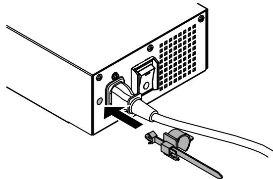
2. 请参照下图，调节位置，固定电源线固定器。
