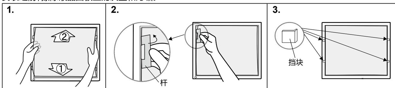
1. 将屏幕保护膜卡入面板边框的槽中,先下(1)后上(2)。
