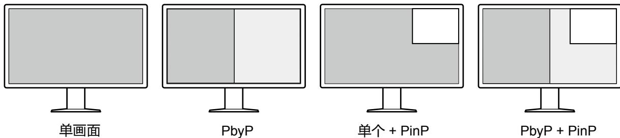
显示器提供了One Cable PbyP功能，它只使用一根DisplayPort电缆在PbyP模式下显示图像。HDMI输入现在可与RadiForce系列一起使用。PinP模式允许您显示来自其他源的图像，如笔记本电脑。
