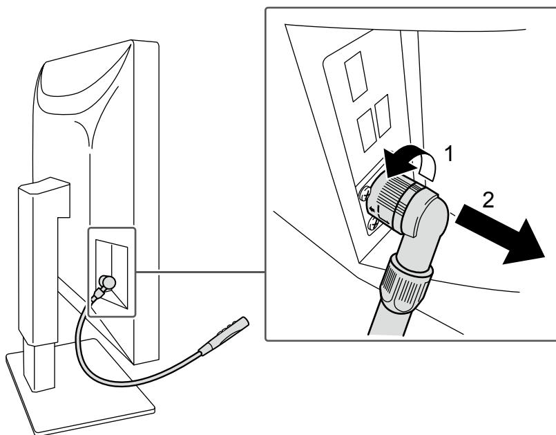
要拆下它,请按图中位置1所示的方向旋转连接到显示器的区域并将其拉出。
