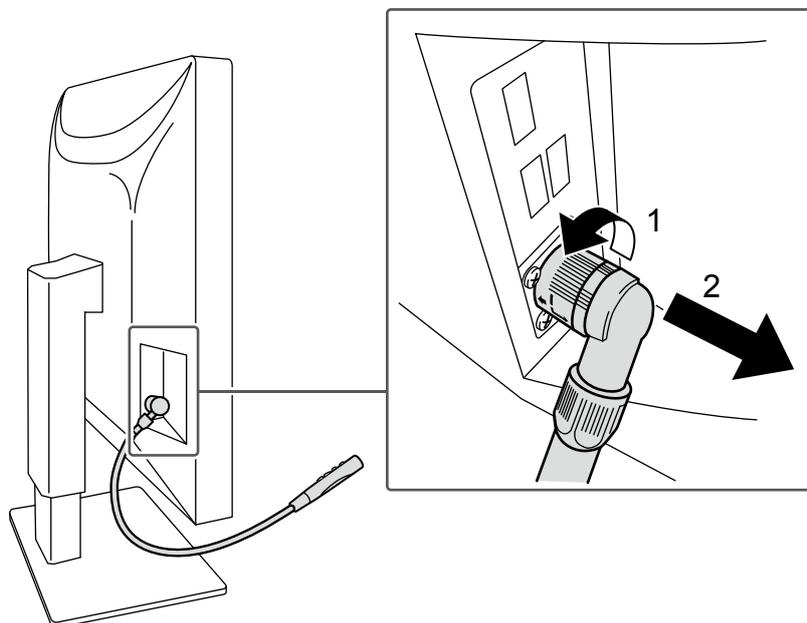
Pour le détacher, faites pivoter la partie attachée au moniteur dans la direction indiquée par la légende 1 sur l'image, et retirez-le.
