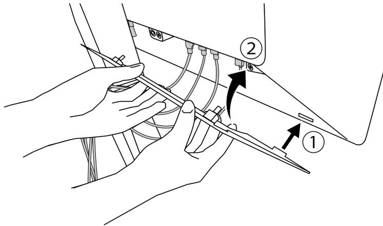
Exemple : Installation du couvercle à câbles (à droite)
