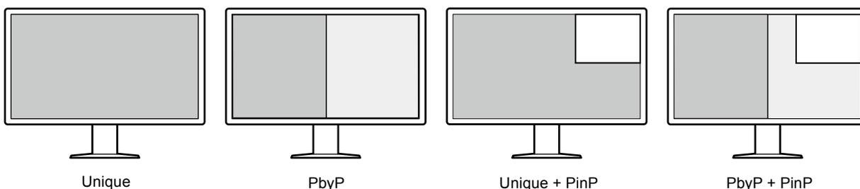
Le moniteur dispose de la fonction One Cable PbyP, qui permet d'afficher les images en mode PbyP à l'aide d'un unique câble DisplayPort.
