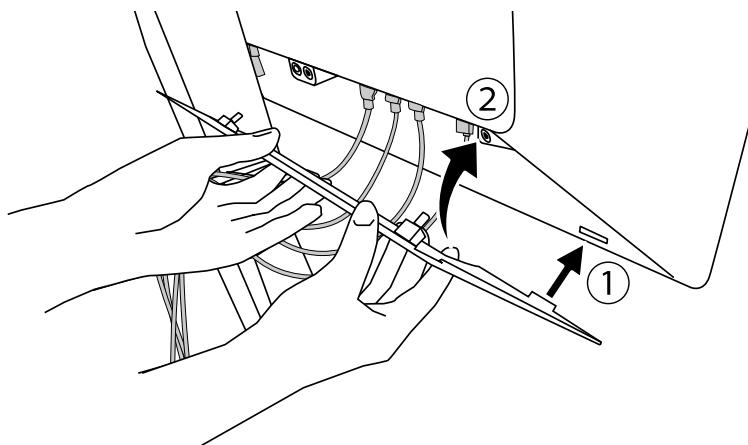
Пример: Установка кабельной крышки (справа)
