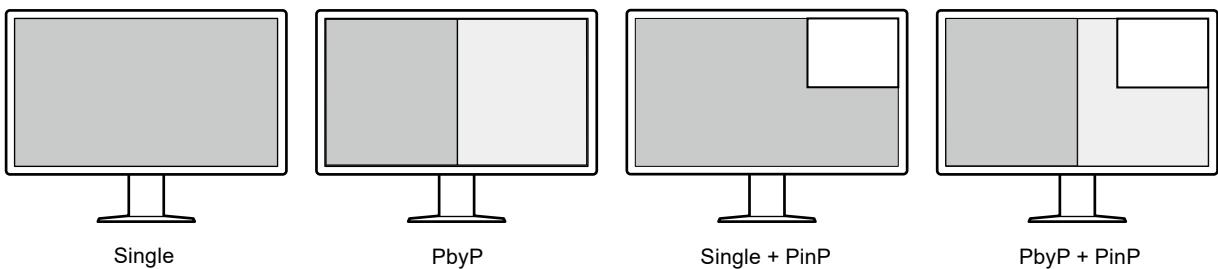
Монитор поддерживает функцию One Cable PbyP. Она позволяет отображать изображение в режиме PbyP, используя всего один кабель DisplayPort.
