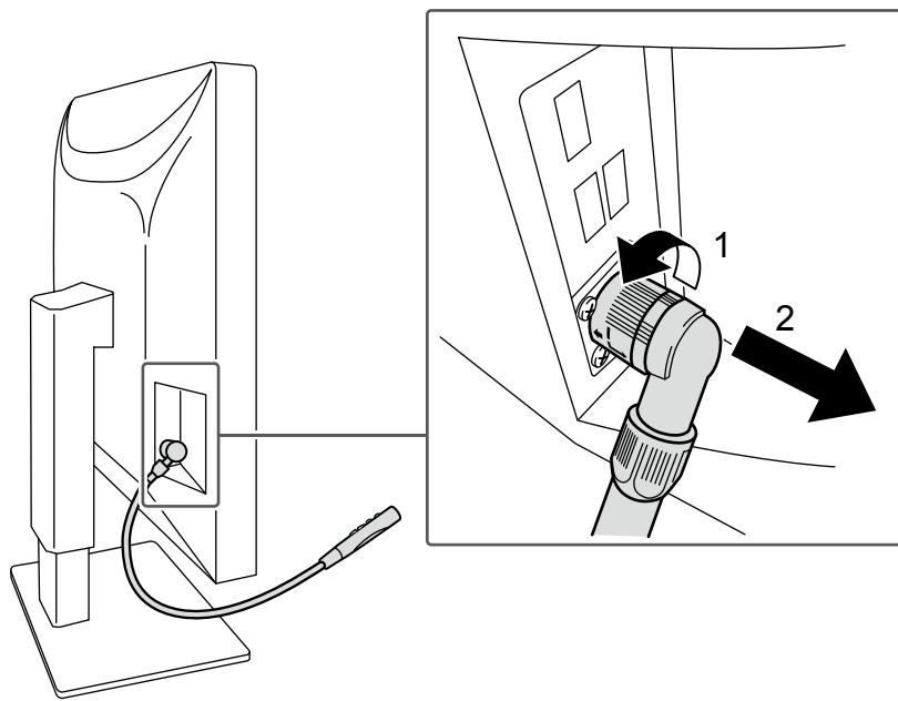
Для отключения поверните подключенную к монитору часть, в направлении, указанном на рисунке стрелкой 1, затем потяните от монитора.
