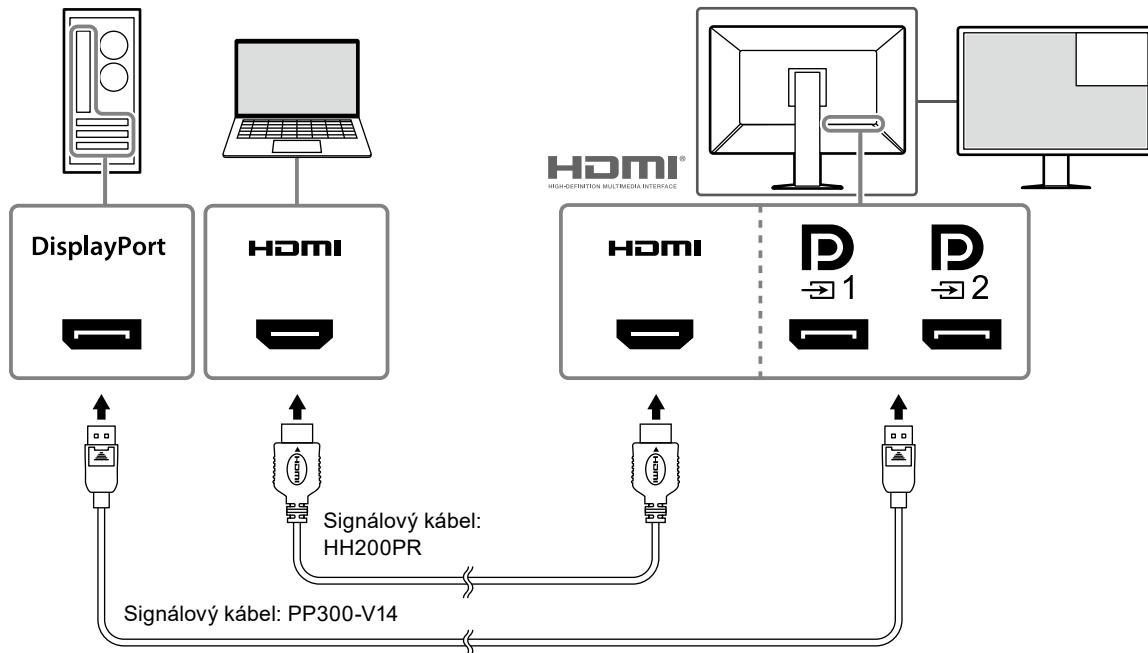
\* Príklad zobrazenia podokna pomocou rozhrania HDMI
