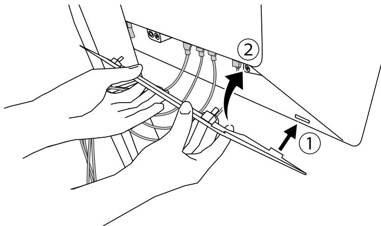
Príklad: Nasadenie krytu kábla (vpravo)
