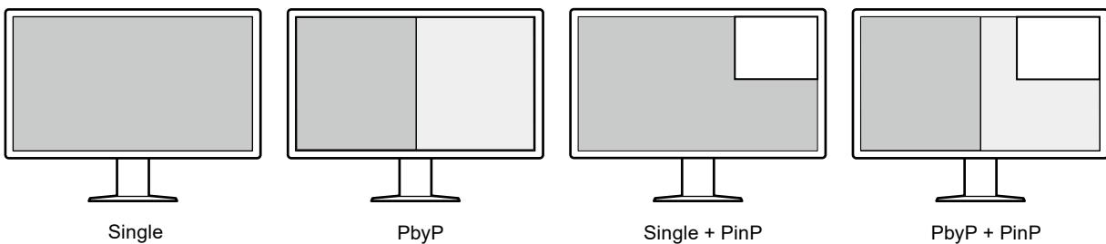
Monitor poskytuje funkciu One Cable PbyP, ktorá zobrazuje obrazy v režime PbyP iba pomocou jedného kábla DisplayPort.
