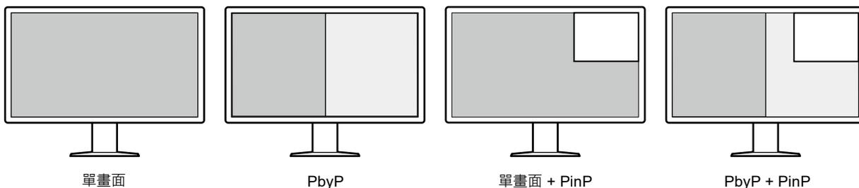
螢幕提供 One Cable PbyP 功能，讓您只需使用一條 DisplayPort 纜線便可在 PbyP 模式下顯示影像。RadiForce 系列現已提供 HDMI 輸入。PinP 模式可讓您顯示其他來源的影像，例如筆記型電腦。
