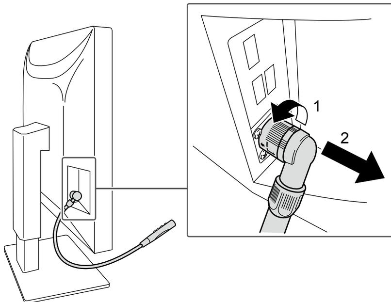
若要拆下聚光燈，請按照圖中位置 1 所示方向旋轉連接到螢幕的區域，然後拉出。
