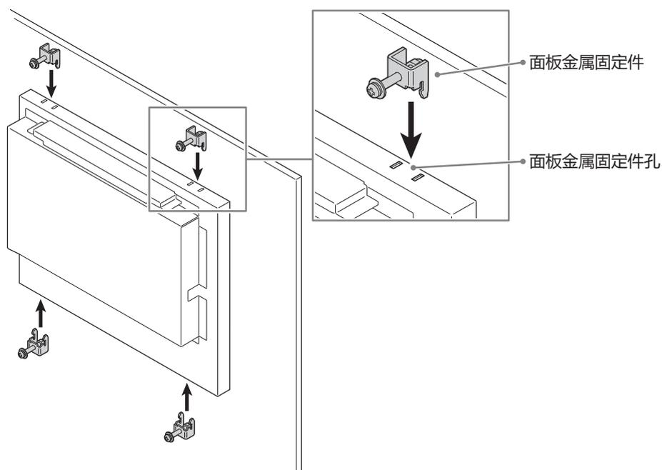
3. 在确保将面板金属固定件的分叉端正确插入显示器上的面板金属固定件孔中的同时，用规定的扭矩（0.6 N·m至0.7 N·m）拧紧面板金属固定件的螺丝，将其固定到位。
