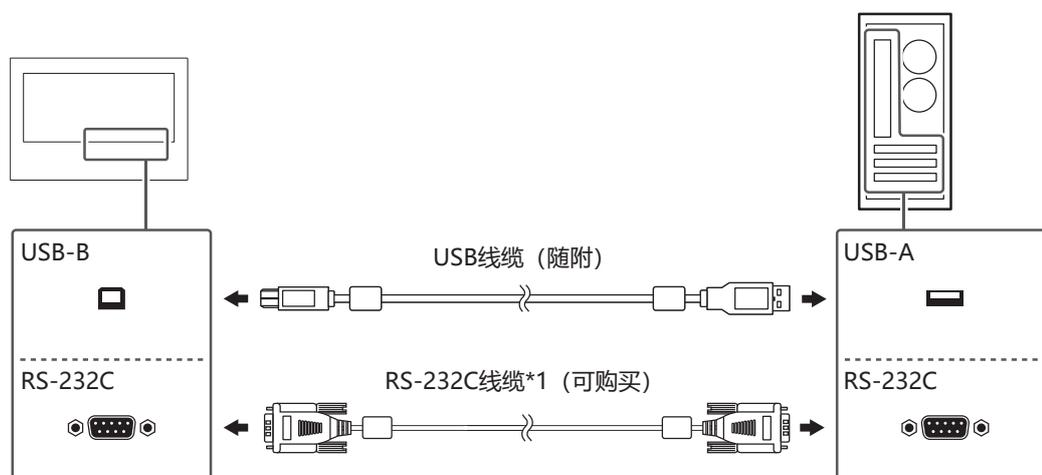
\*1 十字头式。显示器上的接口类型是D-Sub 9针。在默认设定中，禁用了RS-232C串行传输。有关如何更改该设定的详细信息，请参用户手册中的“Administrator Settings菜单功能”。
