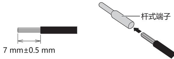
3. 将电线插入接线端子，用平头螺丝刀拧紧夹紧螺丝，尖端宽度为 $2.5\text{ mm}$ （建议扭矩： $0.5\text{ N}\cdot\text{m}$ 至 $0.6\text{ N}\cdot\text{m}$ ）。
