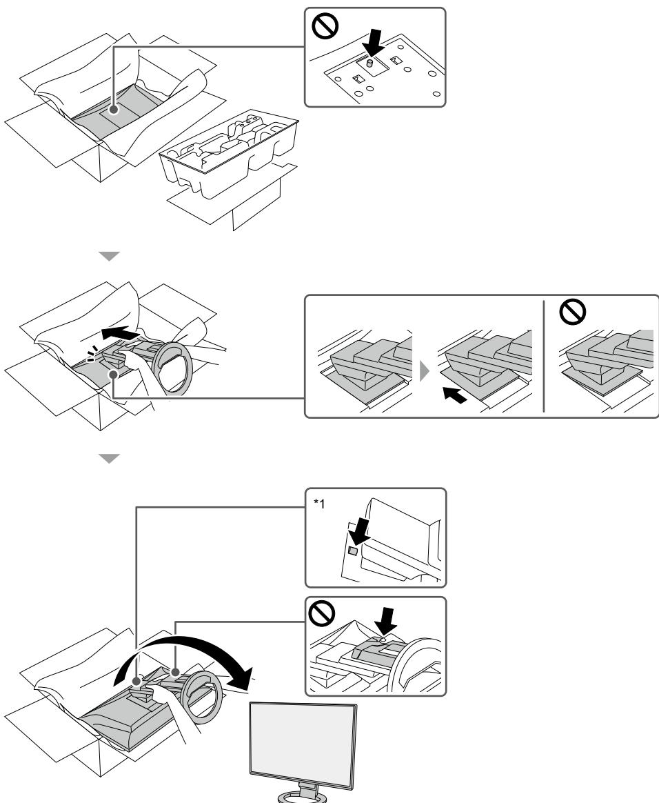
\*1 Le bouton de verrouillage est utilisé uniquement pour retirer le pied du moniteur.
