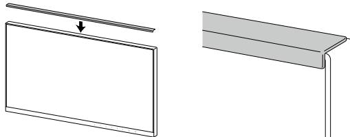
4. Установите краевую опору в выровненном положении, следя за тем, чтобы между поверхностью панели ЖК-монитора и краевой опорой не было зазоров.
