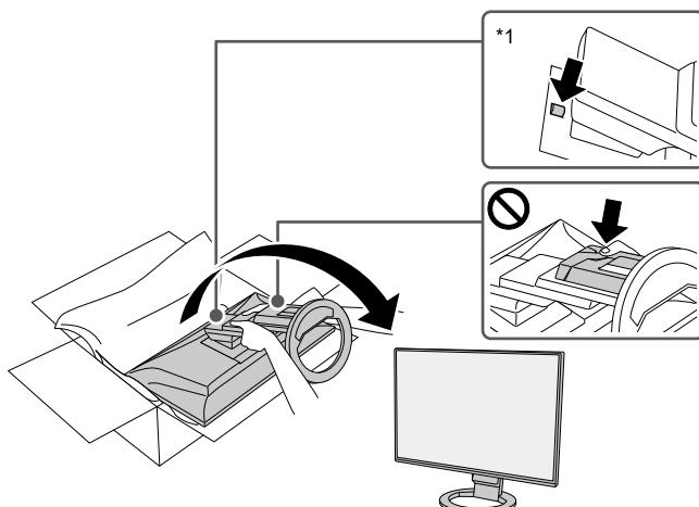
\*1 Кнопка блокировки используется только для снятия стойки с монитора.
