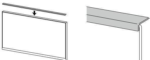
4. Installez l'attache de façade d'écran à l'emplacement ainsi déterminé, en veillant à ne pas laisser d'espace entre la surface du panneau LCD et l'attache de façade d'écran.
