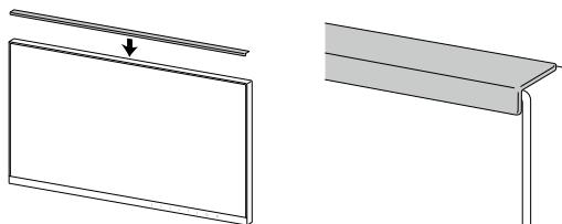
4. Bringen Sie die Randabstützung an der ausgerichteten Position an und achten Sie dabei darauf, dass keine Lücken zwischen der Oberfläche des LCD-Bildschirms und der Randabstützung entstehen.
