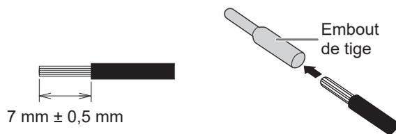
3. Insérez les fils dans le terminal et serrez les vis de serrage à l'aide d'un tournevis plat d'une largeur de pointe de 2,5 mm (couple recommandé : 0,5 N·m à 0,6 N·m).
