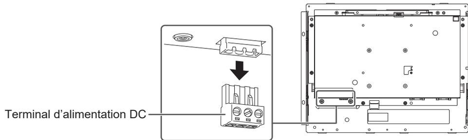
2. Dénudez l'isolant du fil (longueur de dénudage : 7 mm ± 0,5 mm). Si un traitement de l'extrémité est nécessaire, fixez un embout de tige (ferrule). Utilisez des embouts fabriqués par Phoenix Contact.
