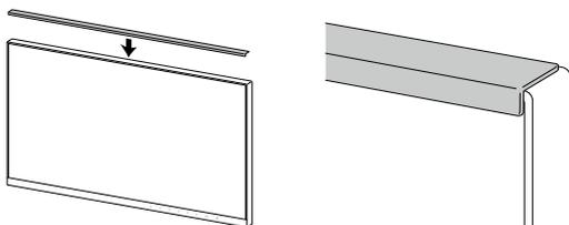
5. 在对齐后的位置安装边缘支撑，同时确保液晶面板表面和边缘支撑之间无缝隙。
