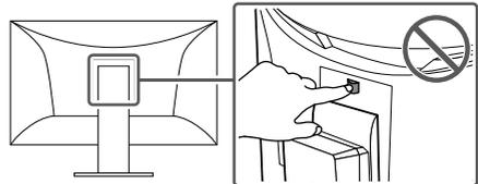
本產品配備一個鎖定按鈕，使顯示器固定在支架上。在其他情況下，因顯示器已從支架拆下，使用該鎖定按鈕可能造成產品損壞或人身傷害。
