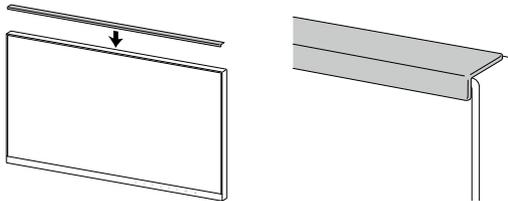
5. 將角落托架安裝至對準的位置，同時確認液晶面板表面和角落托架之間沒有空隙。
