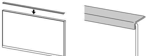
5. Bringen Sie die Randabstützung an der ausgerichteten Position an und achten Sie dabei darauf, dass keine Lücken zwischen der Oberfläche des LCD-Bildschirms und der Randabstützung entstehen.
