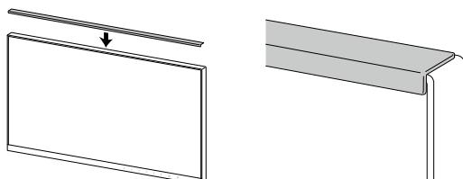
5. Installez l'attache de façade d'écran à l'emplacement ainsi déterminé, en veillant à ne pas laisser d'espace entre la surface du panneau LCD et l'attache de façade d'écran.
