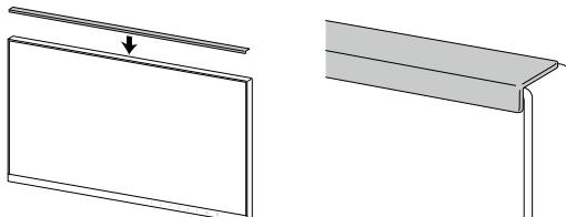
5. Установите краевую опору в выровненном положении, следя за тем, чтобы между поверхностью панели ЖК-монитора и краевой опорой не было зазоров.
