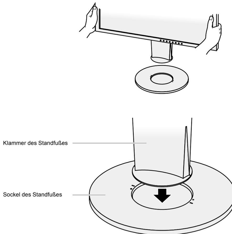
**4. Drehen Sie die Klammer des Standfußes im Uhrzeigersinn, bis sie einrastet.**
