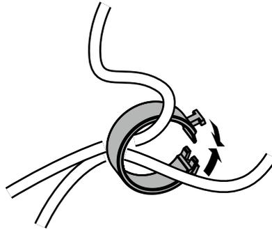
3. Befestigen Sie den geschlossenen Kabelhalter am Standfuß.
