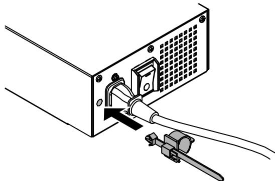
**2. Отрегулируйте его положение, чтобы надежно закрепить держатель шнура питания, как показано на рисунке ниже.**
