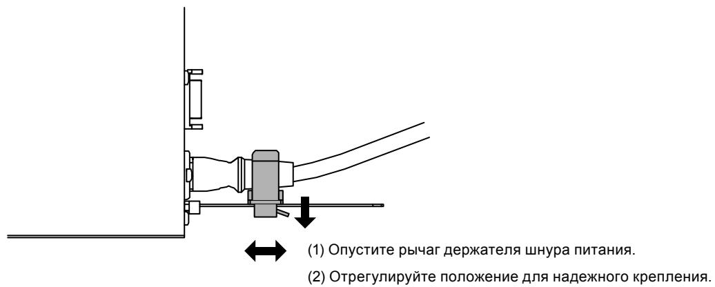
**3. Для предотвращения отсоединения шнура питания надежно закрепите держатель шнура питания.**
