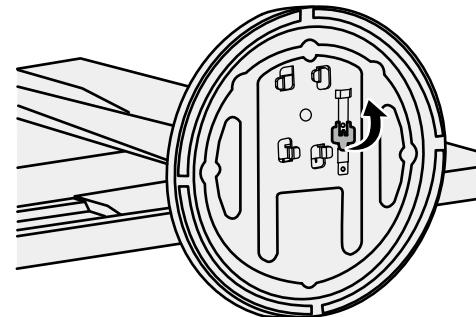
3. 按逆时针方向旋转支架底座可卸下支架底座。
