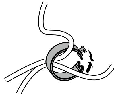
3. 保持电缆固定器闭合的同时将电缆固定器安装到支架上。
