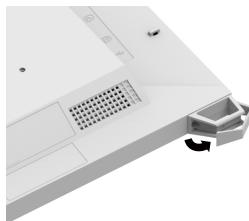
2. 卸下将支腿固定到显示器的螺钉。
