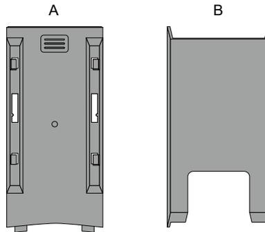
1. Richten Sie die Nasen von (A) an den Befestigungsteilen des Standfußes aus.
