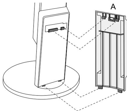
2. Schieben Sie (A) nach unten, um die Nasen an den Befestigungsteilen des Standfußes zu sichern.
