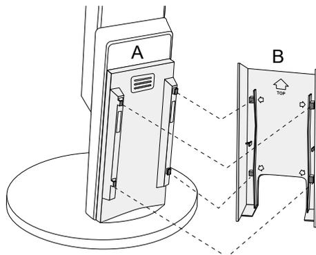
4. Legen Sie die Kabel zwischen (A) und (B) und richten Sie (B) nach (A) aus.
