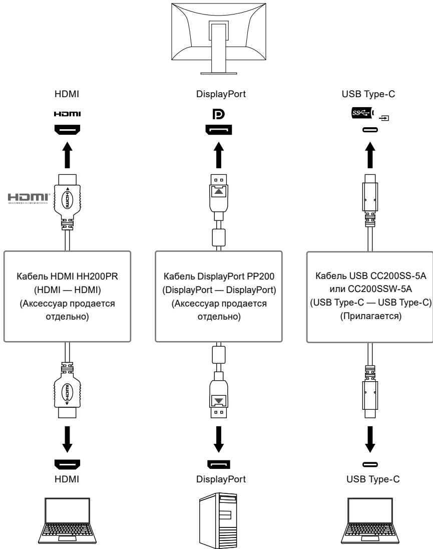
Если два ПК подключены к одному монитору, можно связать входные сигналы с портами USB для использования устройства USB, подключенного к монитору, с обоих ПК путем переключения между ними. Подробнее см. в разделе «[KVM](#)» (стр. 29).
