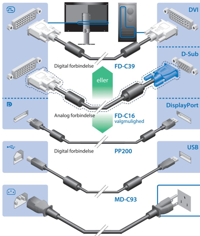
\*USB ledningen er nødvendig til kalibrering. Kontroller at monitor og PC er forbundet med USB ledningen.
