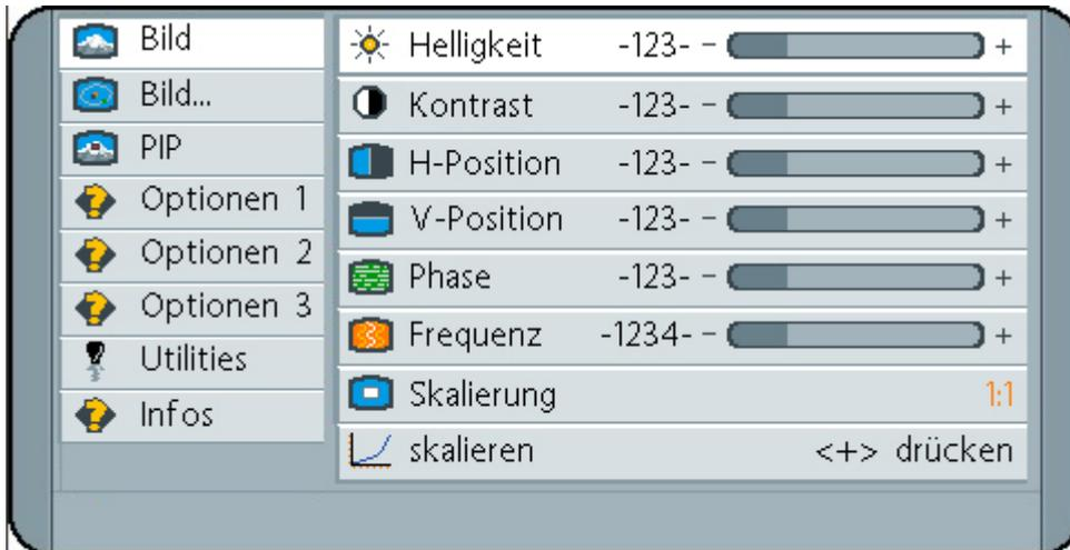
Das OSD variiert je nach der gerade dargestellten Signalquelle analog RGB (VGA)-, digital DVI- oder analog Video- (FBAS,S-Video) Signal.
