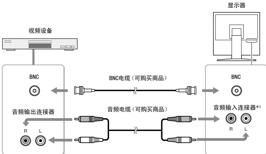
\*1 本设备只配有一个系统的声频输入插孔。PC或视频设备、请选择一个连接。不论选择哪种输入,都有声频输出。
